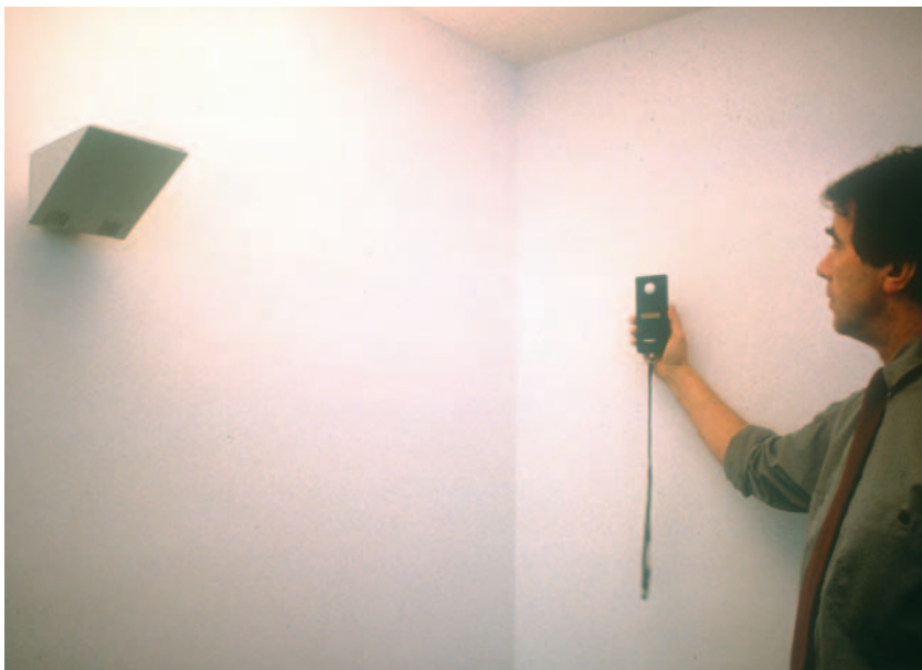
Überprüfung von Beleuchtungsplanungen
